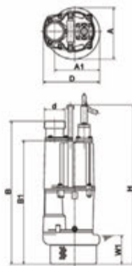
W1: Niveau minimum de pompage
