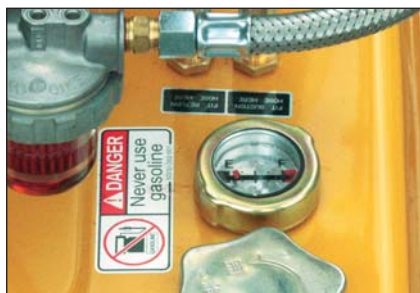
VAL avec indication du contenu du réservoir, (non le KB).
