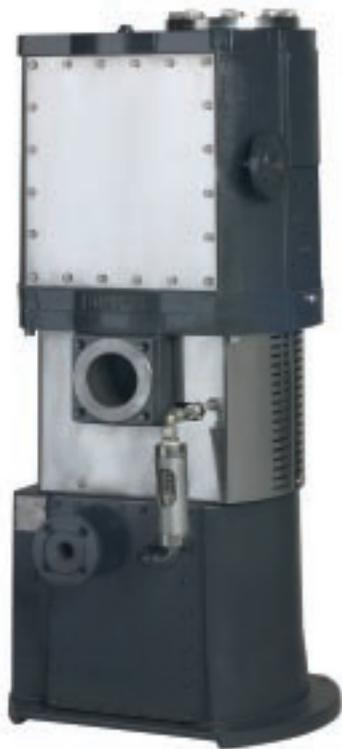
La **SIHI<sup>dry</sup>** est une pompe à vide entièrement sèche avec 2 rotors à vis, sans joints d'étanchéité d'arbres, ni engrenages de synchronisation, ni fluide de lubrification. La gamme de débits disponibles s'étend de 100 jusqu'à 1.000 m<sup>3</sup>/h avec un seul étage de compression. En association avec des pompes « Roots », des capacités bien plus grandes peuvent également être atteintes.
