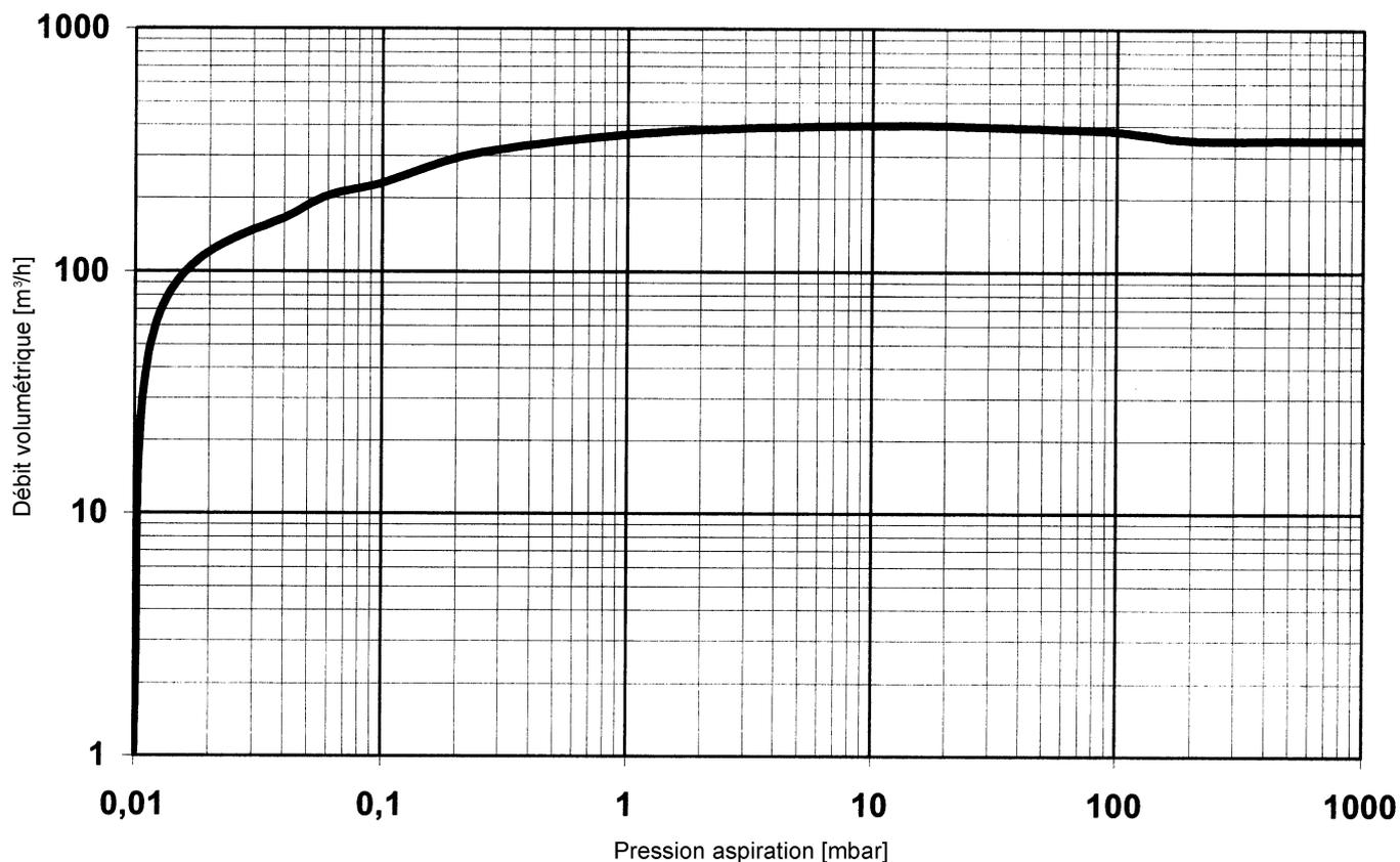
Chaque point de fonctionnement en dessous de la courbe caractéristique peut être obtenu par variation de vitesse en mode de pilotage « DYNAMIQUE ».
