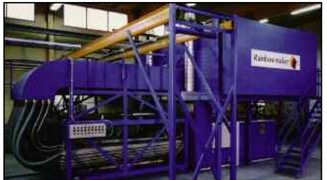
Le système GS150 permet de mesurer automatiquement la température dans le procédé de trempe et de cintrage du verre.
