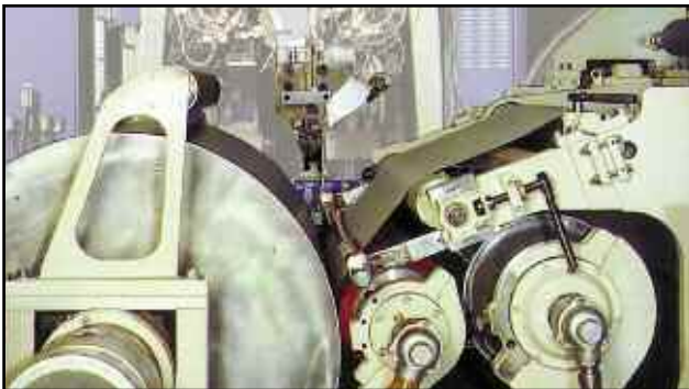
Le système EC150 permet de mesurer la température des bords des feuilles de papier et de surveiller ainsi la température idéale pour le procédé de revêtement.
