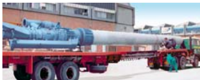
36 brûleurs, 20 MW unitaire, mixtes fuel/gaz destinés à une centrale thermique en Roumanie
