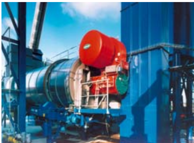
Tambour de séchage Ammann avec une pompe de brûleur EMS de l'entreprise KRAL
