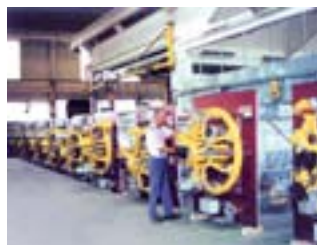
L'une des plus grosses tuyères fuel/charbon (167 MW) en cours de transport
