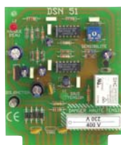
DSN 51 mono-électrode à temporisation variable automatique
