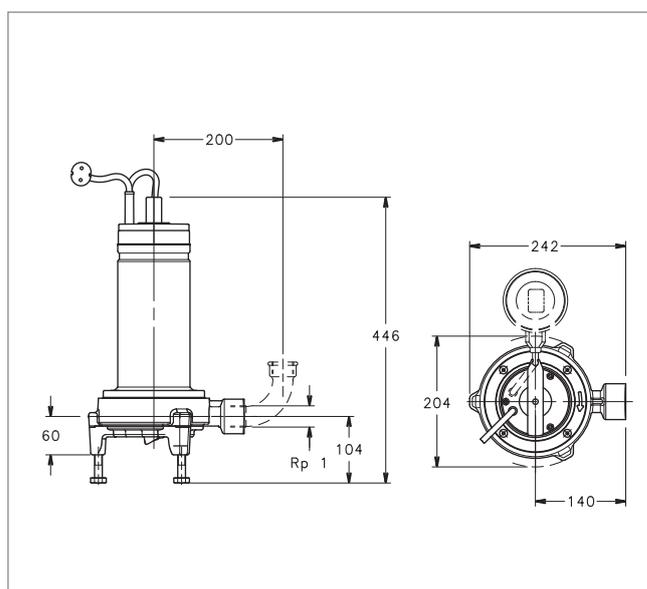
**La pompe Delinox Grinder DXG est équipée d'un dispositif de broyage novateur, extrêmement efficace et particulièrement fiable, qui lui permet de transformer les solides en un fluide pouvant être pompé.**
