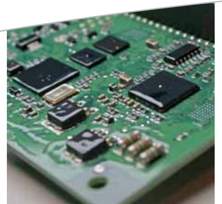
Les cartes électroniques peuvent être recouvertes d'un vernis protecteur pour des environnements agressifs.
