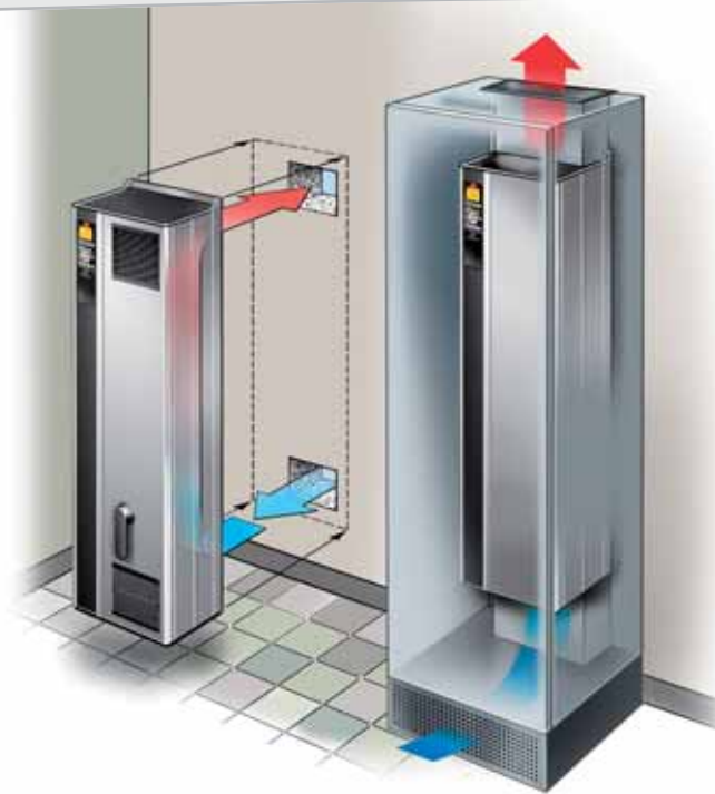
Les appareils en protection IP 00 peuvent être montés dans des armoires Rittal standards. Un kit de gaines permet de dévier l'air de refroidissement sans passer dans l'armoire électrique. Jusqu'à 85% de la chaleur est ainsi by-passée.
