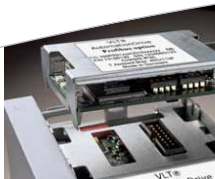
La carte option bus de terrain est embrochable par la face avant. On peut la placer soit pour que les câbles passent par le haut, soit tête en bas, pour faire passer les câbles par le bas.
