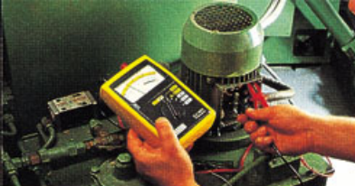
Contrôle de l'isolement des enroulements d'un moteur.
