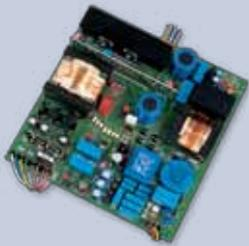
Les ballasts électroniques garantissent le fonctionnement économique et fiable des lampes UV Spektrotherm®.
