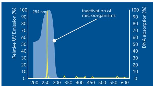
La lampe à UV monochromatique Spektrotherm® émet à une longueur d'onde de 254 nm, ce qui correspond à la gamme maximale de désinfection efficace du spectre.
