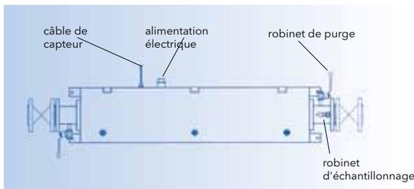
Surveillance et contrôle UV grâce à des capteurs UV étalonnés très sélectifs
