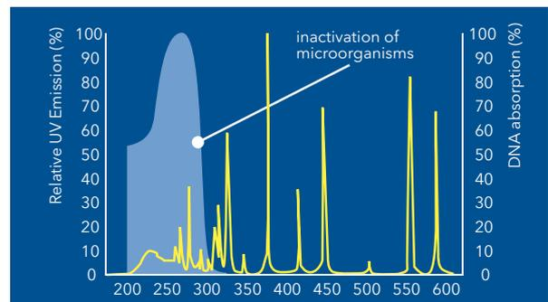
Les lampes à moyenne pression émettent un spectre à large bande, dont la plupart est en dehors de la partie du spectre nécessaire à la désinfection. De plus, la formation de sous-produits ne peut pas être exclue.
