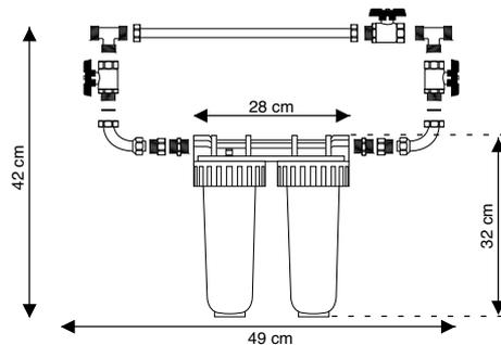
Nous vous recommandons de monter la station BIPLEX avec le **système by pass** (code 494350) qui permet l'entretien et le changement des cartouches sans coupure d'eau.
