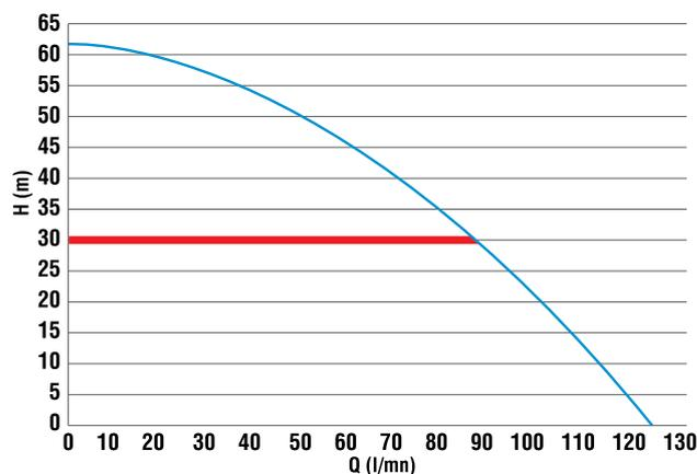
La courbe résultant du système piloté par le régulateur de fréquence devient celle du graphique ci-dessus (en considérant la valeur SP par défaut à 3,0 bar). On obtient avec SP = 3,0 bar que le système est en mesure d'assurer la pression constante paramétrée pour des débits de 0 à 90 litres/minute.
