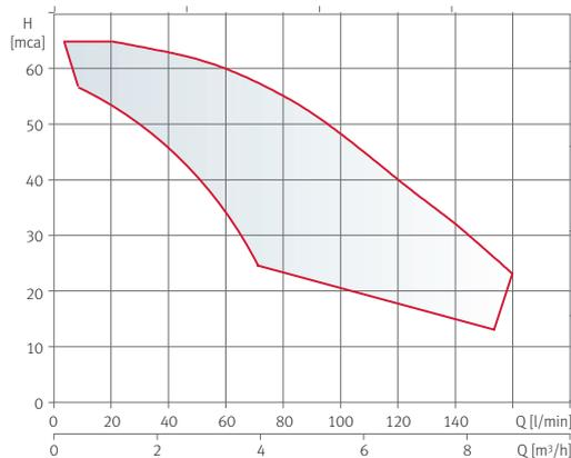
Courbes hydrauliques CPE2 à 2900 rpm
