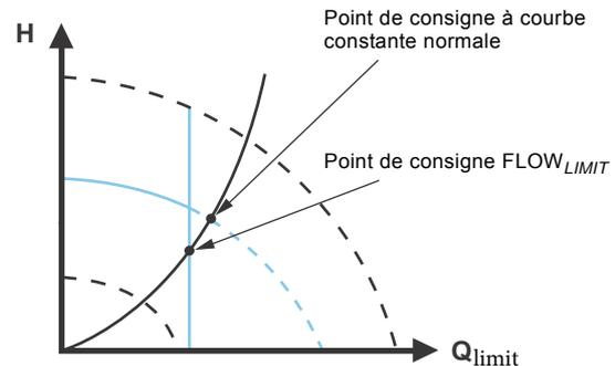
Fig. 30 Courbe constante avec FLOW<sub>LIMIT</sub>
