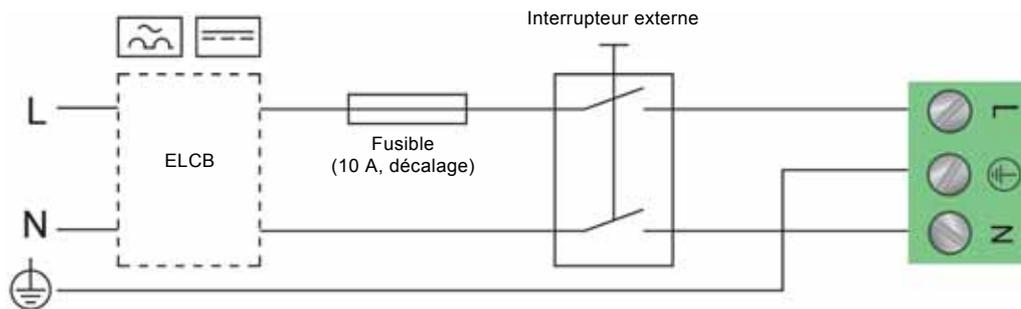
Fig. 52 Exemple de connexion traditionnelle, 1 x 230 V ± 10 %, 50/60 Hz
