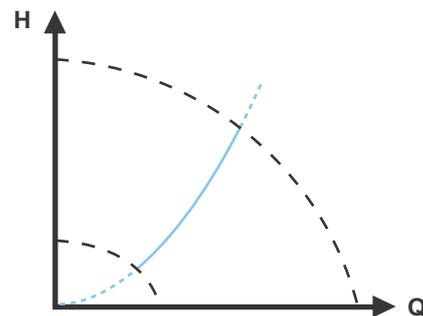
Fig. 22 Régulation à température constante
