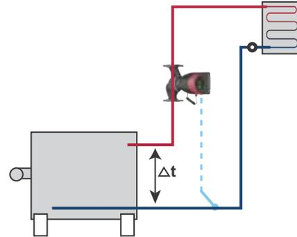
Fig. 21 Température différentielle
