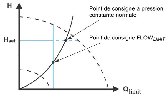
Fig. 29 Régulation à pression constante avec FLOW<sub>LIMIT</sub>
