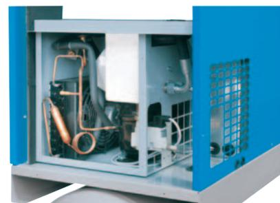
Le sécheur est équipé de série d'un dispositif d'évacuation des condensats automatique intelligent.
