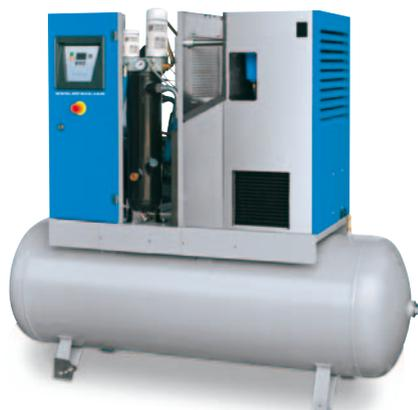
Seuls deux panneaux doivent être déposés pour accéder aux composants d'entretien standard. Le niveau d'huile est visible de l'extérieur pour un contrôle rapide et immédiat. Pour remplacer ou tendre la courroie, seul le panneau latéral doit être déposé.
