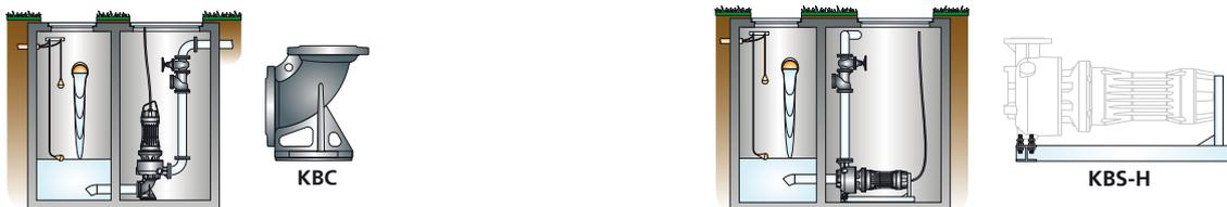
Dans l'installation à sec VERTICALE, l'électropompe est montée sur une embase coudée, sur laquelle est fixé le tuyau d'aspiration à bride.
