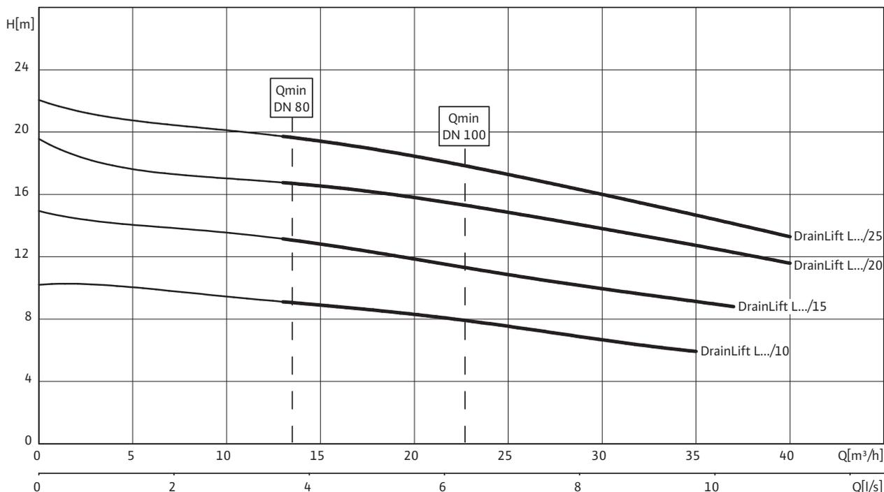
Conformément à EN 12056-4,6.1, respecter une vitesse d'écoulement (dans la conduite de refoulement) entre 0,7 et 2,3 m/s. Les valeurs  $Q_{min}$  indiquées se rapportent au diamètre intérieur des tuyaux en acier à paroi normale.
