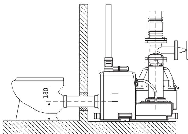
Schéma d'installation Wilo-DrainLift L
