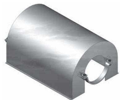
La plaque anti-vortex est fixée dans le domaine de l'alimentation de la pompe à moteur immergé et élimine les tourbillons d'air pendant le service. L'utilisation de la plaque anti-vortex permet une alimentation ciblée du fluide véhiculé au groupe. De cette façon, le recouvrement d'eau minimum requis est minimisé et le réservoir mieux mis à profit.
