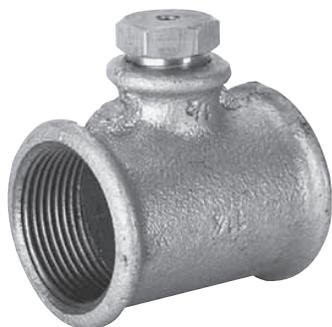
Pour la vidange de la conduite de refoulement en cas de mise en service de l'installation avec réservoirs d'air tout en sachant que l'air dans la conduite de refoulement sert au remplissage du réservoir d'air. Tailles de construction : R 1¼, R 1½ et R 2. La soupape est fabriquée en acier galvanisé.
