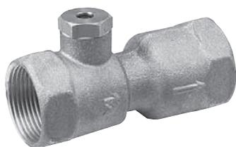
Pour aérer et éviter qu'une sous-pression ne se forme dans la conduite de refoulement. Montage au-dessus du niveau de l'eau. Tailles de construction : R 1 1/4, R 1 1/2 et R 2. La soupape est fabriquée en laiton.
