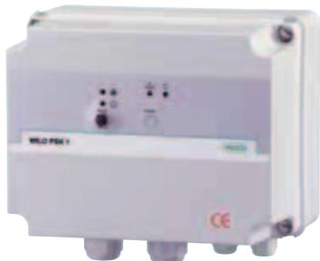
Appareils de commande pour le raccordement d'une pompe à la distribution d'eau à partir de forages et de citernes (pour habitations familiales et collectives), comprenant 2 électrodes plongeantes et 4 supports pour le montage mural. Possibilités de raccordement pour 2 électrodes plongeantes et 1 interrupteur à pression/interrupteur à flotteur. Conçu pour 1~230 V et 3~400 V. Avec protection moteur intégrée, convient pour montage mural
