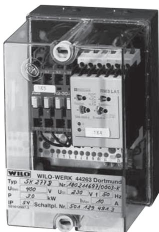
Coffret de commande pour montage mural pour la protection contre la marche à sec d'une pompe avec raccordement indirect sur le réseau, avec 3 électrodes plongeantes comme capteur de signal (masse, niveau haut, niveau bas).
