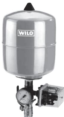
Kit de pièces détachées montées en dérivation sur la tuyauterie côté refoulement pour la construction surajoutée d'une installation à une pompe fonctionnant automatiquement en fonction de la pression en combinaison avec le coffret de commande ER-1. Le réservoir sous pression à membrane au-dessus sert à la temporisation des fuites.
