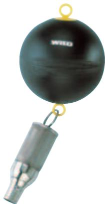
Filtre d'aspiration flottant à grosses mailles, ouverture de maille 1,2 mm, avec raccord de tube 1¼" pour prélèvement en surface de l'eau de pluie préfiltrée (voir chapitre systèmes de filtrage).
