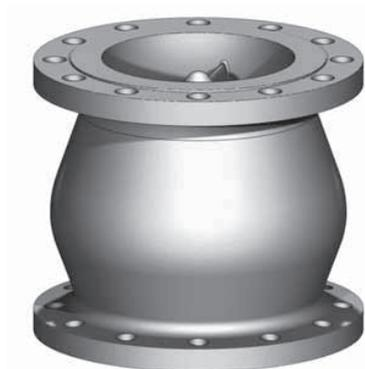
Les clapets anti-retour empêchent la circulation de retour du débit et ainsi la vidange de la conduite de refoulement, la marche arrière de la pompe à moteur immergé arrêtée et un éventuel blocage de la pompe dû à des matières revenant par ruissellement. En outre, ceci permet de réduire les coups de bélier pouvant se produire en raison du basculement de retour du débit après la mise à l'arrêt de la pompe à moteur immergé.
