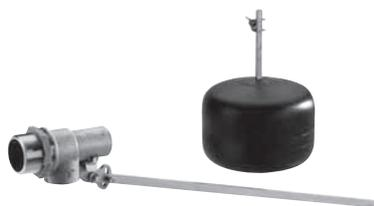
Vanne à flotteur pour l'utilisation avec des réservoirs de stockage ouverts d'un volume utile de 1 000 l maximum pour la régulation du niveau. Vanne à flotteur R ½ comme soupape de distribution en liaison avec la vanne à membrane.
