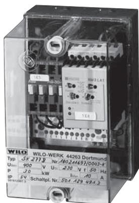
Coffret de commande pour montage mural pour la protection contre la marche à sec d'une pompe avec raccordement indirect sur le réseau, avec 3 électrodes plongeantes comme capteur de signal (masse, niveau haut, niveau bas).
