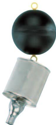
Comme filtre d'aspiration à grosses mailles G, mais filtre d'aspiration fin flottant avec une ouverture de maille de 0,23 mm. Protection idéale contre l'encrassement de l'installation d'alimentation en aval en cas d'eau de pluie pas préfiltrée.
