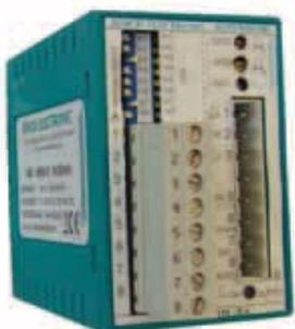
Module supplémentaire pour l'équipement de la gamme de coffrets de commande du système Wilo-CC en vue de la sélection des signaux (valeur minimale) de deux à huit points de mesure pour déterminer le point critique.
