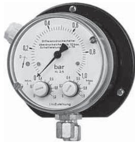
Pour montage mural comme manomètre à contact à pression différentielle. Avec points de commutation réglables pour la permutation automatique des vitesses max./min. ou max. à min. des pompes simples ou doubles Wilo avec moteurs à vitesses variables. Uniquement en association avec les coffrets de commande correspondants.
