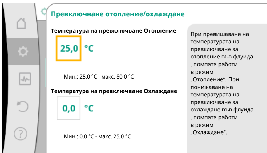
Fig. 57: Превключване отопление/охлаждане_температури на превключване
