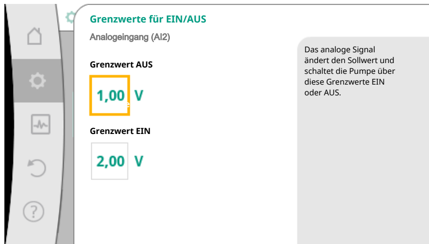
Fig. 74: Grenzwerte zur EIN/AUS-Steuerung über Analogsignale
