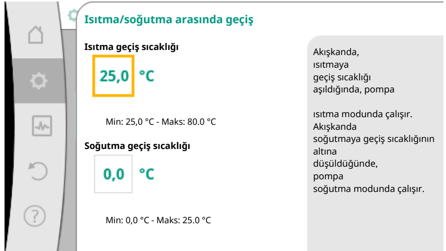
Fig. 57: Isıtma/soğutma_geçiş_sıcaklıkları arasında geçiş
