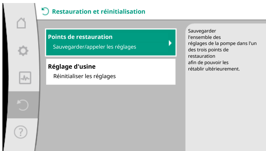
Fig. 85: Points de restauration
