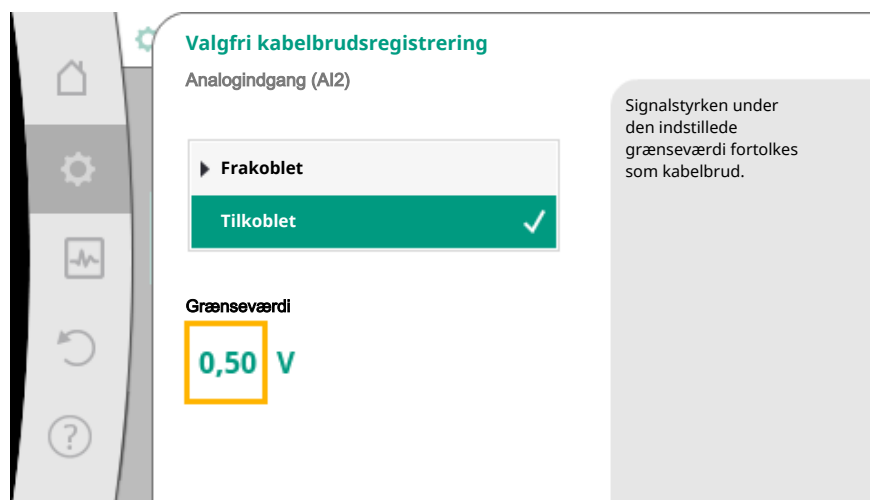
Fig. 72: Grænseværdi for kabelbrud
