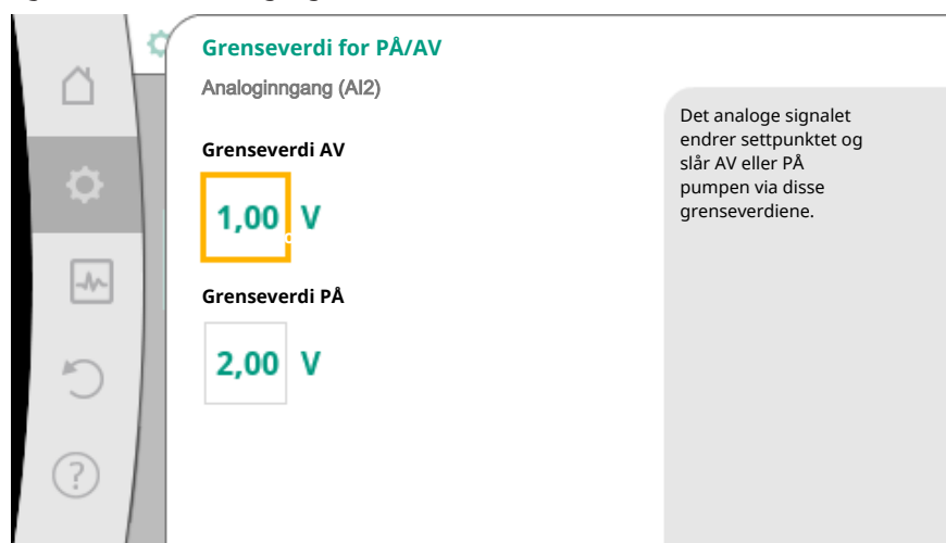
Fig. 74: Grenseverdier for AV/PÅ-styring via analogsignaler
