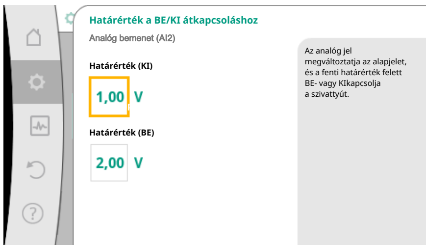
Fig. 74: Az analog jelekkel végzett BE/KI vezérlés határértékei
