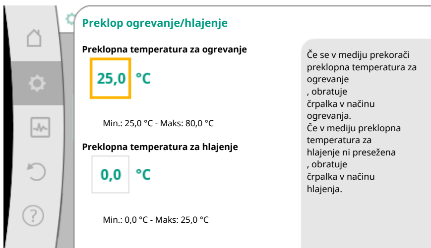
Fig. 57: Preklop ogrevanje/hlajenje_preklopne temperature
