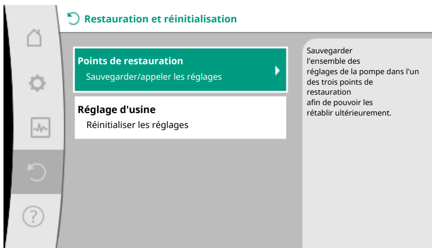
Fig. 83: Points de restauration
