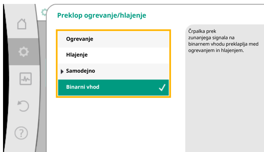
Fig. 58: Preklop ogrevanje/hlajenje_binarni vhod
