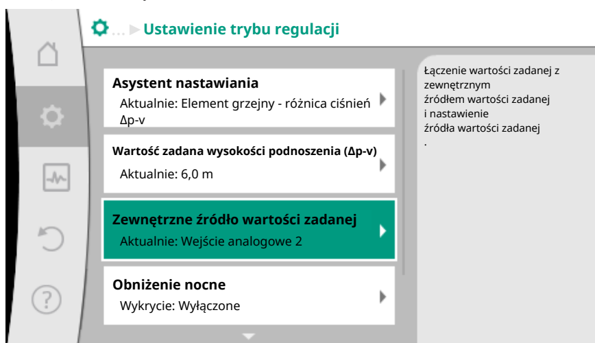
Fig. 66: Zewnętrzne źródło wartości zadanej
