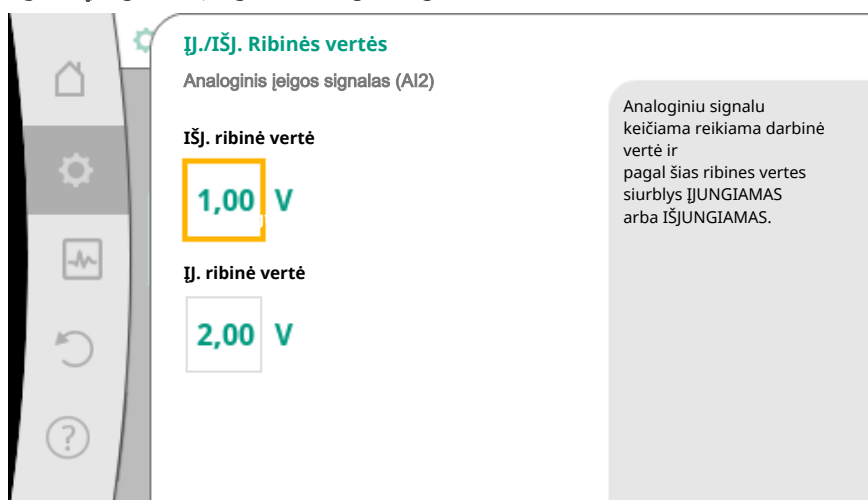
Fig. 74: Įjungimas/išjungimas valdymo analoginiu signalu ribinė vertė
