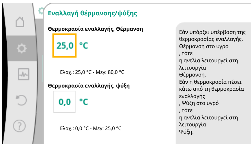
Fig. 57: Εναλλαγή θέρμανση/ψύξη_Θερμοκρασίες εναλλαγής
