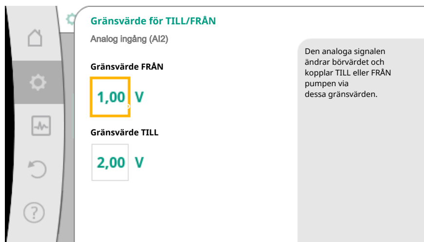
Fig. 74: Gränsvärden för TILL/FRÅN-styrning via analog signal
