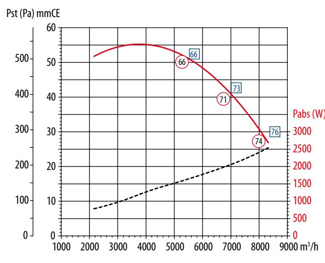
Les diagrammes suivants sont valables pour une densité de l'air de 1,2 kg/m<sup>3</sup>.
