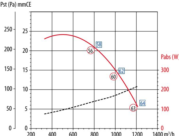
**VSA EC - VSB EC - VSAT EC - VSBT EC**CENTRIFUGES - ACTION - ECM < 7 000 M<sup>3</sup>/H
