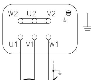
Raccordement sur réseau triphasé
