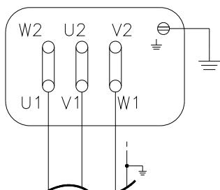
Raccordement sur réseau triphasé
