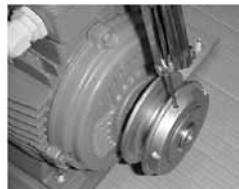
Desserrer les 2 vis de blocage 6 pans creux, régler le flasque mobile et resserrer les 2 vis en veillant à ce qu'elles appuient au fond des 2 rainures, pour ne pas détériorer le filetage de la poulie.
