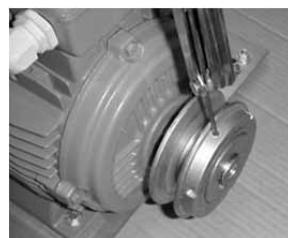
Desserrer les 2 vis de blocage 6 pans creux, régler le flasque mobile et resserrer les 2 vis en veillant à ce qu'elles appuient au fond des rainures, pour ne pas détériorer le filetage de la poulie.
