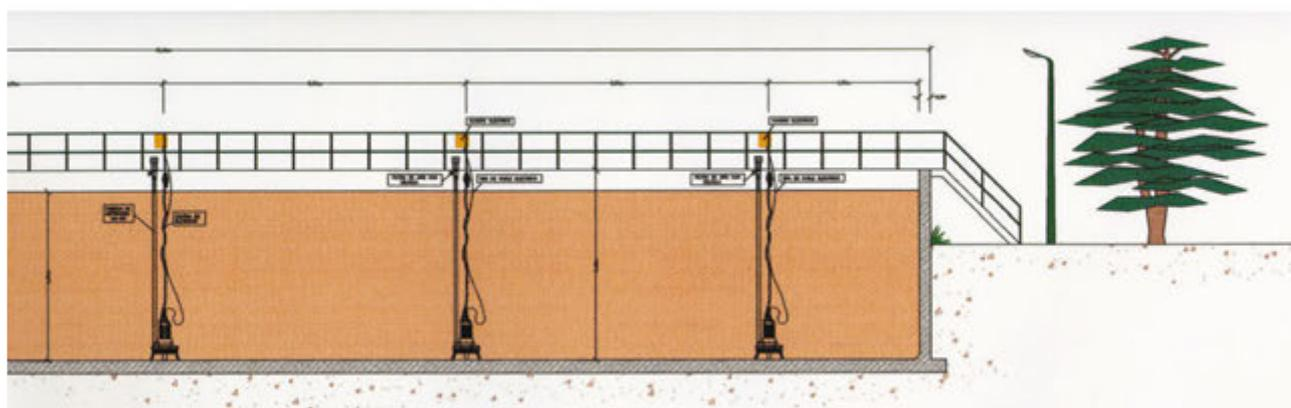
Le système d'aération est constitué d'un surpresseur et d'un aérateur submersible TSURUMI de la série TRN.
