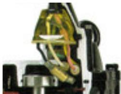
La boite de jonction est située au dessous de l'entrée de câble et participe à l'étanchéité de la pompe, en évitant soigneusement toute pénétration d'eau par capillarité. Cette boite de jonction est réalisée en caoutchouc ou en résine epoxy. Chaque fil est soigneusement dénudé sur quelques millimètres, avant d'être noyé dans cette résine, assurant une étanchéité totale et parfaite à l'entrée de câble.
