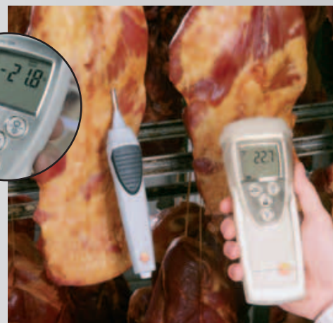
Mesure de température sans fil, transmission de données par radio
