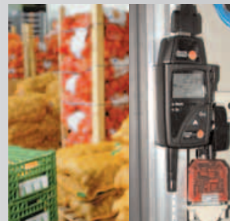
Interrogation des valeurs enregistrées du réseau informatique grâce à l'adaptateur Ethernet
