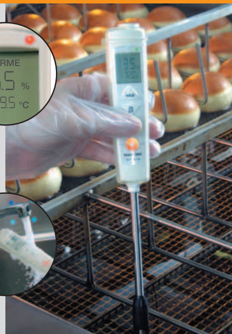
Contrôle de l'huile de friture industrielle et réglage du point de friture optimal dans une friteuse industrielle
