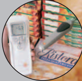
Mesures sans fil avec sondes radio
