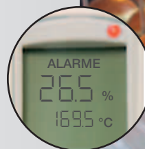
Affichage 2 lignes avec une alarme lors d'un dépassement de valeur limite
