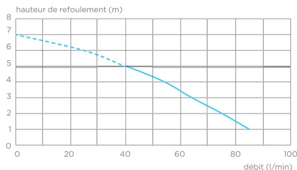
Refoulements vertical et horizontal : ↑ 5 m → 100 m
