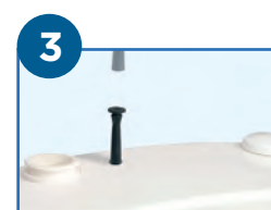
3 Enduire de graisse siliconée avant d'insérer le tube de pressostat du Sanialarm.
