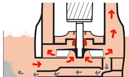
Le Système SAN peut être désactivé. La courbe de la pompe gagne ainsi 1 mètre de colonne d'eau de pression supplémentaire à débit équivalent.
