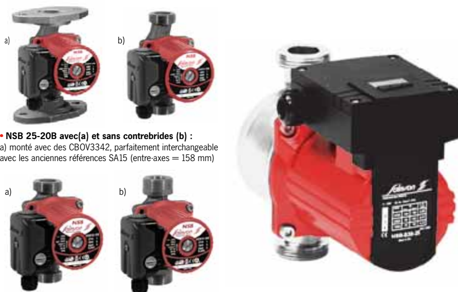
• NSB 15-15B avec et sans adaptateurs : a) NSB 15-15B = entre-axes 130 mm ØG1 b) NSB 15-15B avec kit150 = entre-axes 150 mm ØG11/4. Double possibilité de montage
