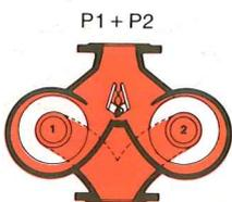
Les deux pompes en fonctionnement permettent sur un réseau donné une augmentation importante du débit.
