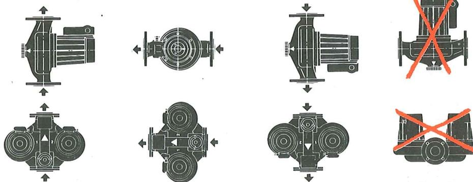
**CX2000 aspiration-refoulement horizontal** (refoulement à droite ou à gauche) :
