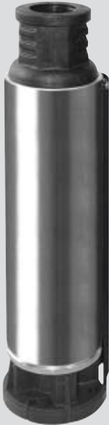
Les pompes hydrauliques de la série K-Series sont constituées par un système multietagé à roues flottantes. Les diffuseurs possèdent des éléments en acier inox aux points d'usure pour réduire les problèmes dus aux particules abrasives et aux blocages dus au sable. Elles sont particulièrement indiquées pour l'élévation d'eau dans les puits d'un diamètre de 4".
