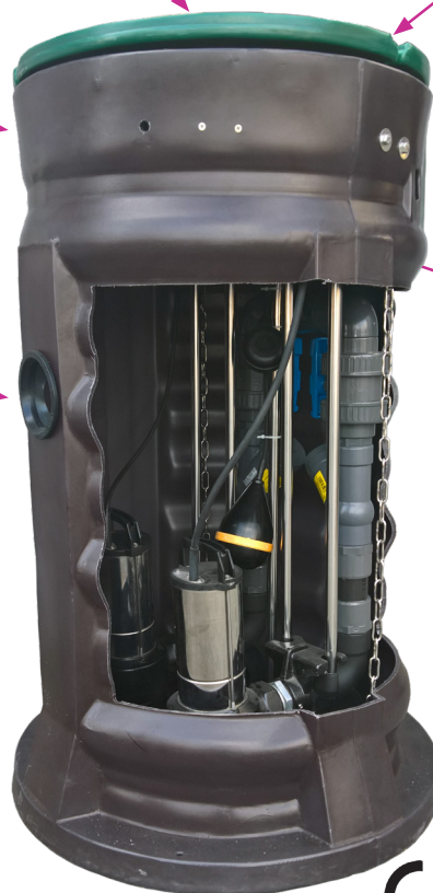
Colonne de refoulement avec 2 pieds d'assise, 2 clapets à boule PVC Socla, 2 vannes, 2 pompes roue Vortex
