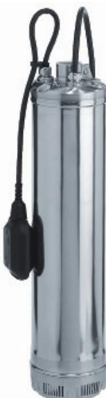
La gamme des pompe de puits ES bénéficie des dernières avancées technologiques et du savoir faire reconnu de FRANKLIN ELECTRIC. Le moteur est encapsulé, protégé par une étanchéité avec double garniture mécanique et toutes les pièces en contact avec le fluide sont en inox.
