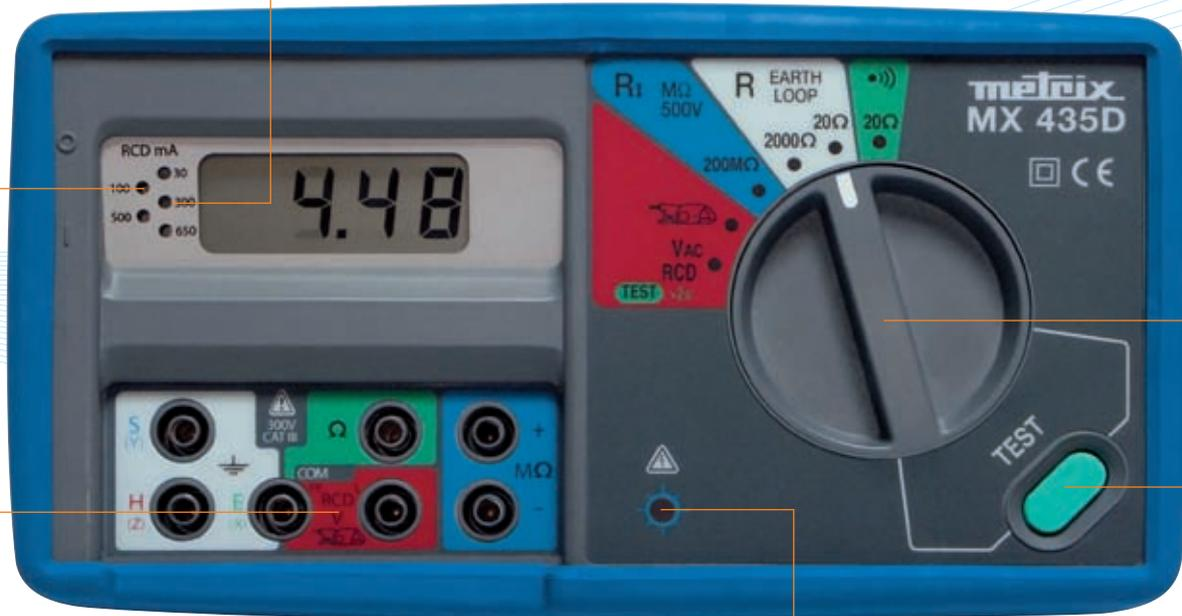
Code de couleurs entre les bornes et le commutateur garantissant des raccordements sans erreur
