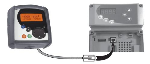
Le variateur détecte automatiquement la présence de la console LCD.
