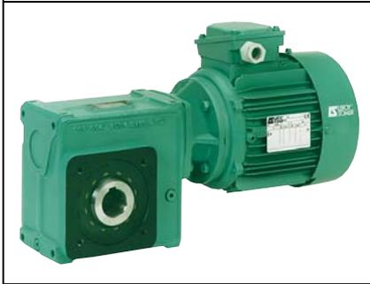
Les motorréducteurs de vitesse Multibloc 2000 à roue et vis sans fin permettent d'adapter la vitesse du moteur électrique à celle de la machine entraînée.
