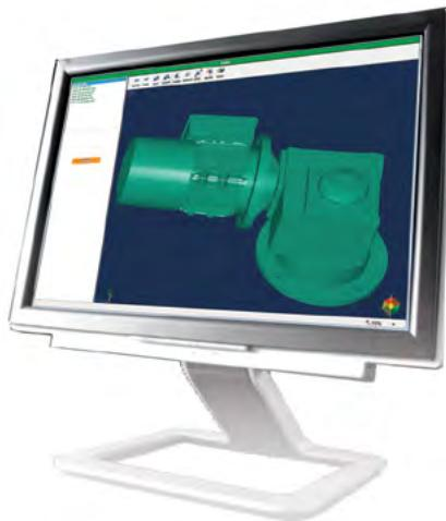
Le configurateur est un outil puissant d'aide à la sélection de moteurs ou de motoréducteurs associés à des variateurs de vitesse. L'évolution continue de ce logiciel a permis de franchir une nouvelle étape avec les moteurs et motoréducteurs IMfinity®, offrant à l'utilisateur la possibilité d'associer le moteur qu'il aura sélectionné au variateur.
