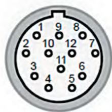
Vue sur l'embase connecteur femelle M23 (Anti-horaire) coté utilisateur
