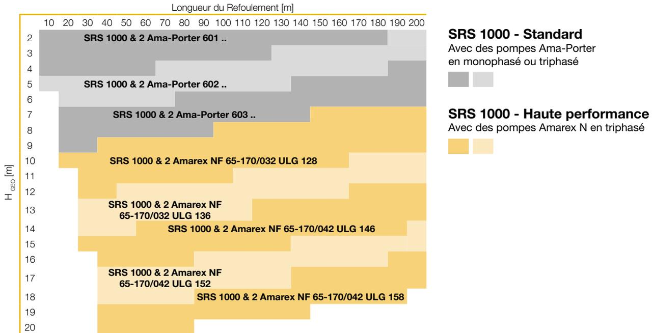
**Sélection rapide d'un poste DN 65 avec réseau en DN 80 pour un débit d'environ 18 m<sup>3</sup>/h**
