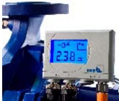
**Description :** PumpMeter est une unité intelligente de surveillance de pompes avec affichage des valeurs mesurées et des caractéristiques de fonctionnement. L'appareil est doté de deux capteurs de pression et d'un module d'affichage. Il enregistre le profil de charge de la pompe pour signaler les potentiels d'optimisation éventuels en termes d'efficacité énergétique et de disponibilité.
