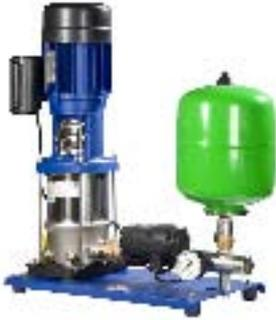
**Description :** surpresseur compact automatique équipé d'une pompe avec réservoir à membrane de 8 litres. Mise en route par la pression et arrêt par le débit.
