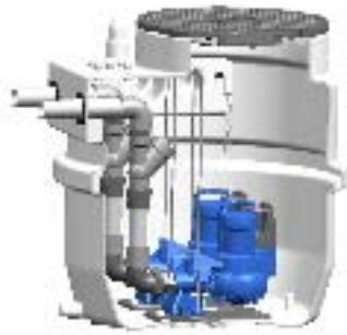
**Description :** poste de relevage inondable pour eaux usées domestiques, équipé d'une ou de deux pompes Ama-Porter F (roue à vortex) ou Ama-Porter S (roue dilacératrice) et système de régulation ICS (Intelligent Control System).
