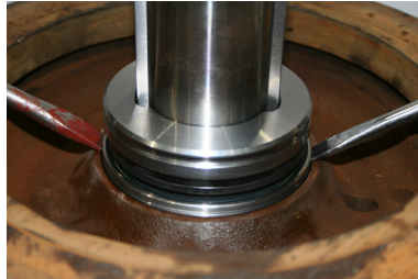
III. 14: Démontage de la garniture mécanique à l'aide de petits pieds de biche
