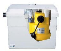
**Description :** réservoir collecteur robuste en matière synthétique (poste sur sol) ou réservoir collecteur en matière synthétique résistant aux chocs avec regard et siphon anti-odeur (poste enterré), équipé d'un groupe submersible Ama-Drainer à fonctionnement automatique avec clapet de non-retour.
