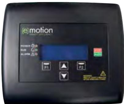
L'e-motion est un variateur de vitesse innovant par sa simplicité. Il permet de faire varier la vitesse du moteur de la pompe pour conserver une pression fixe quelle que soit la demande en débit (dans la limite de la courbe de la pompe).
