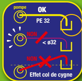
LE RACCORDEMENT POMPE/CUVE
