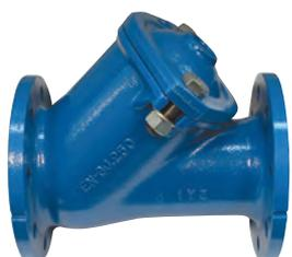
**336** À brides - PN 10 - Corps fonte GS - Boule en d'aluminium revêtue NBR - pas de joint de siège car usinage garantissant l'étanchéité - 70 °C maxi
